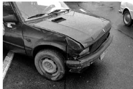
Prednje bočno oštećenje
